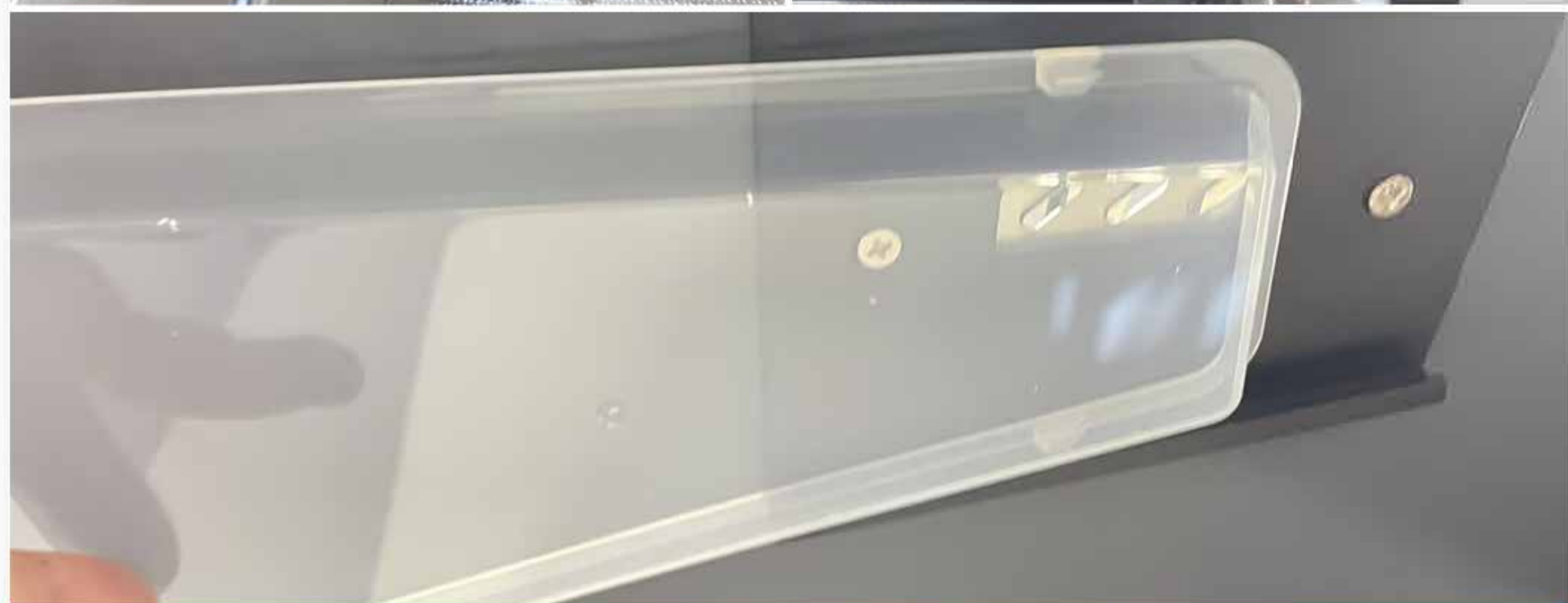
门板与平篮组装，并调整门板，安装装饰盖 挂上接水盘
